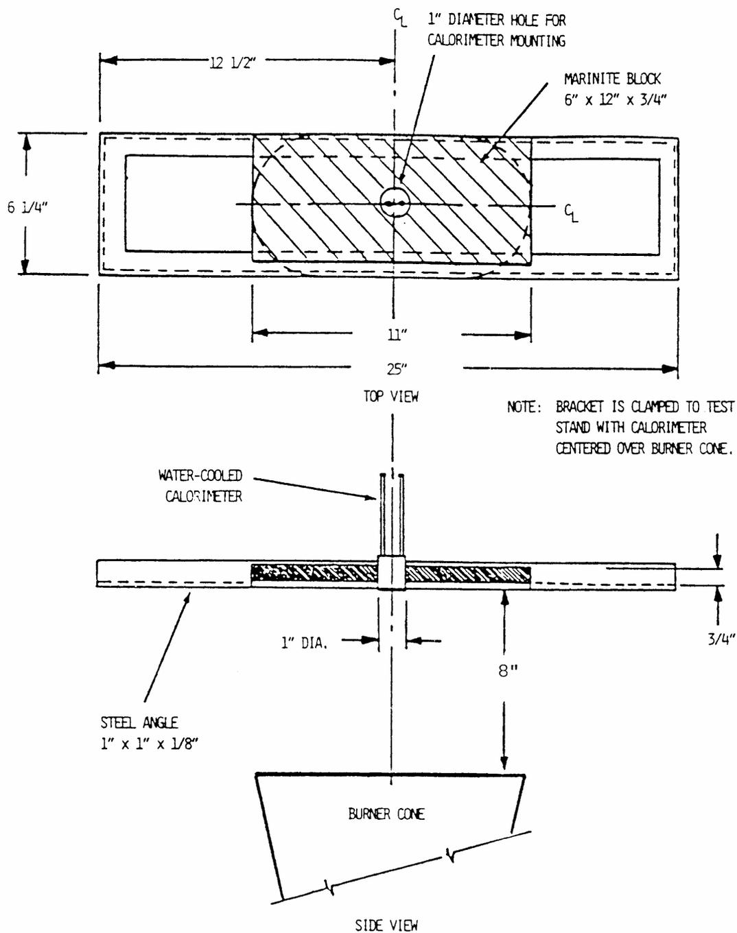
FIGURE 2 CALORIMETER BRACKET
