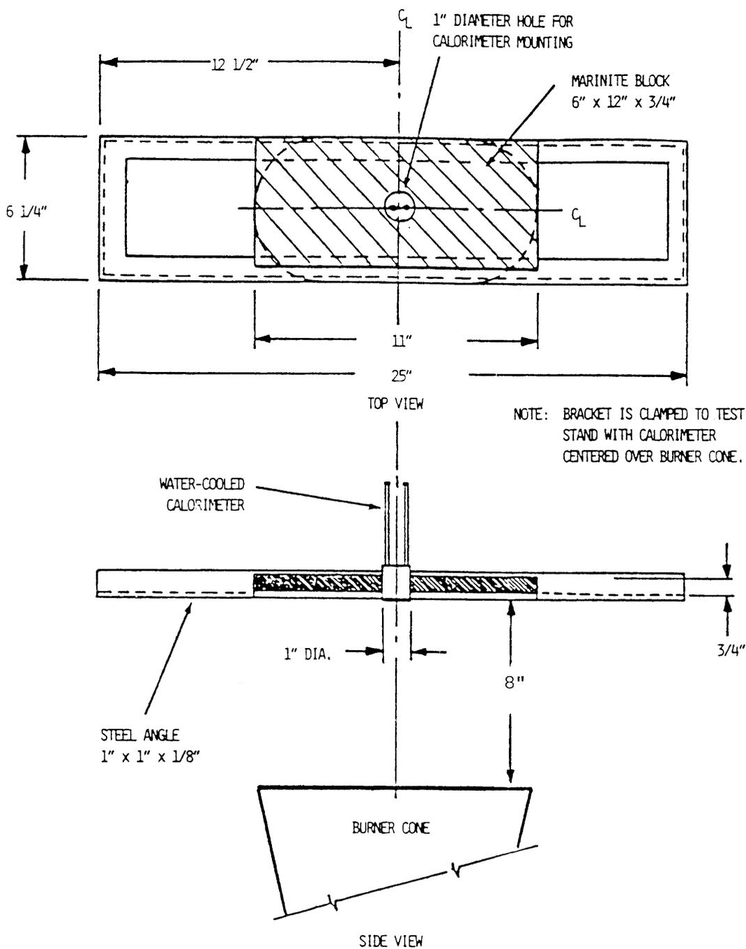
FIGURE 2 CALORIMETER BRACKET
