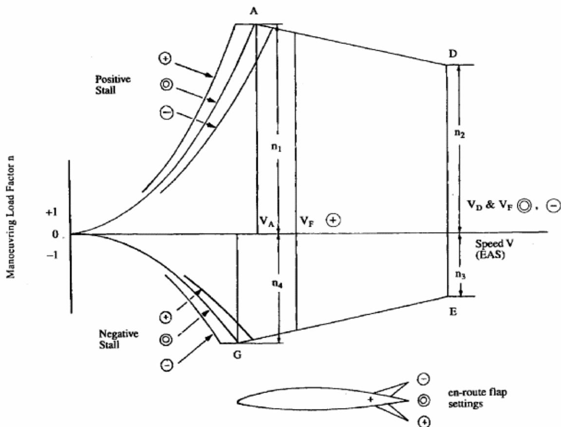
**FIGURE 1 MANOEUVRING ENVELOPE**
