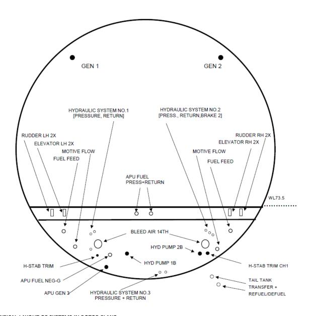
TYPICAL LAYOUT OF SYSTEMS IN ROTOR PLANE FIGURE 4
