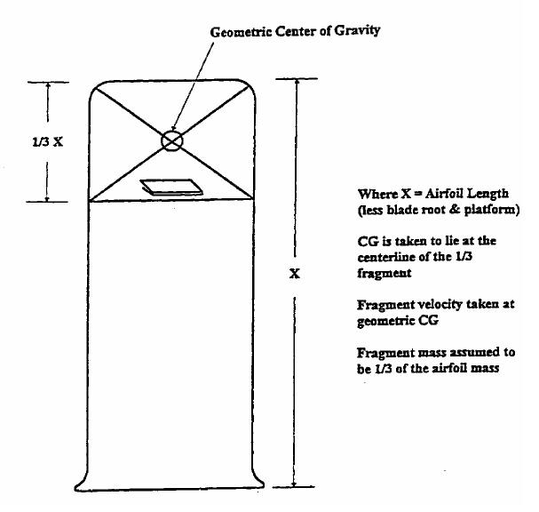
FIGURE 5 – FAN BLADE FRAGMENT DEFINITION
