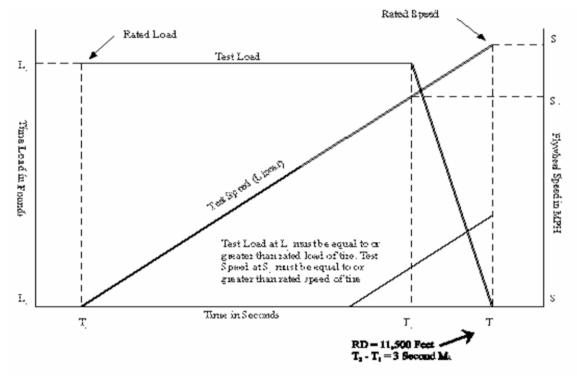
FIGURE 2 GRAPHIC REPRESENTATION OF A RADIONAL LOAD-SPEED-TIME TEST CYCLE
