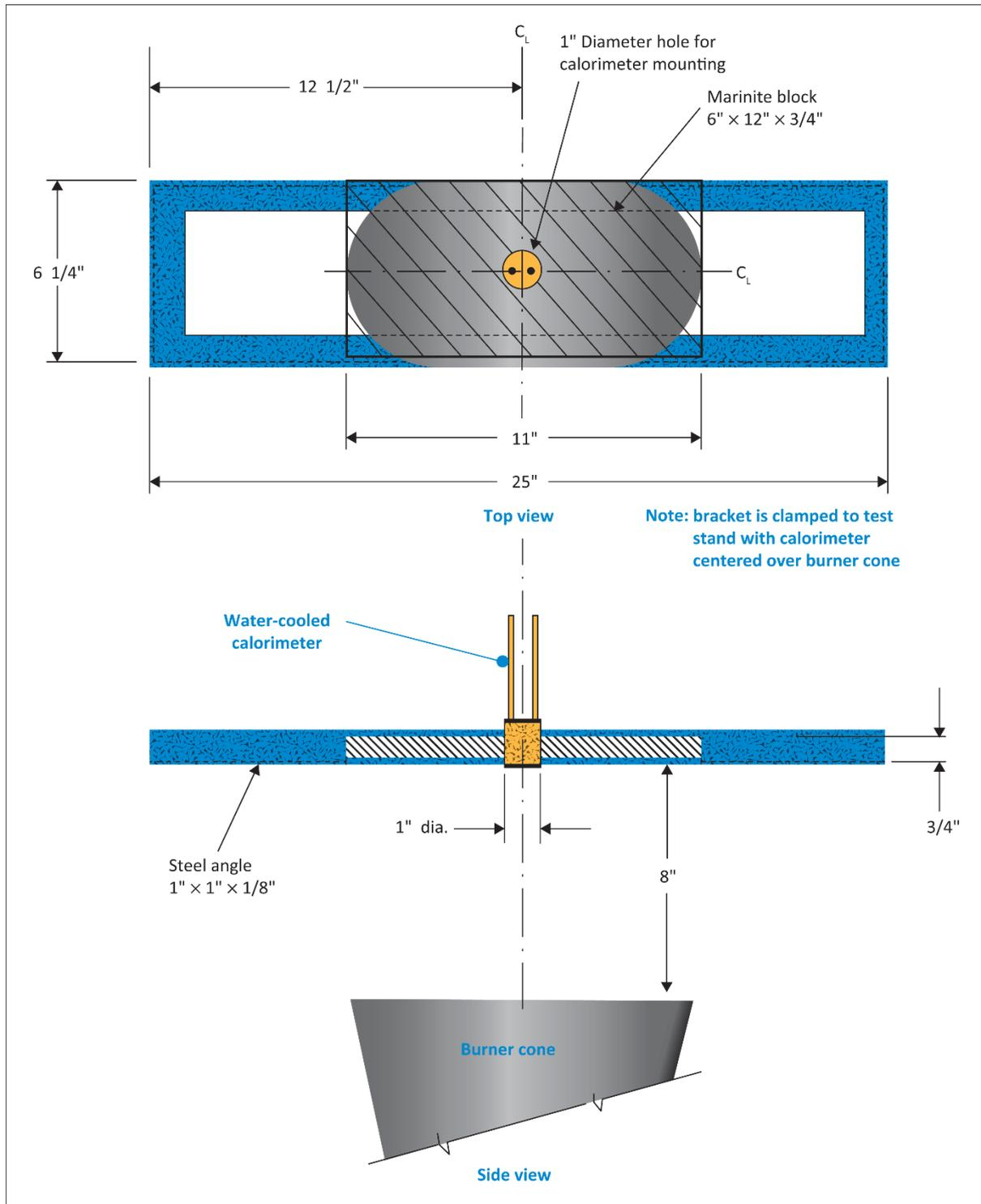
FIGURE 2 CALORIMETER BRACKET
