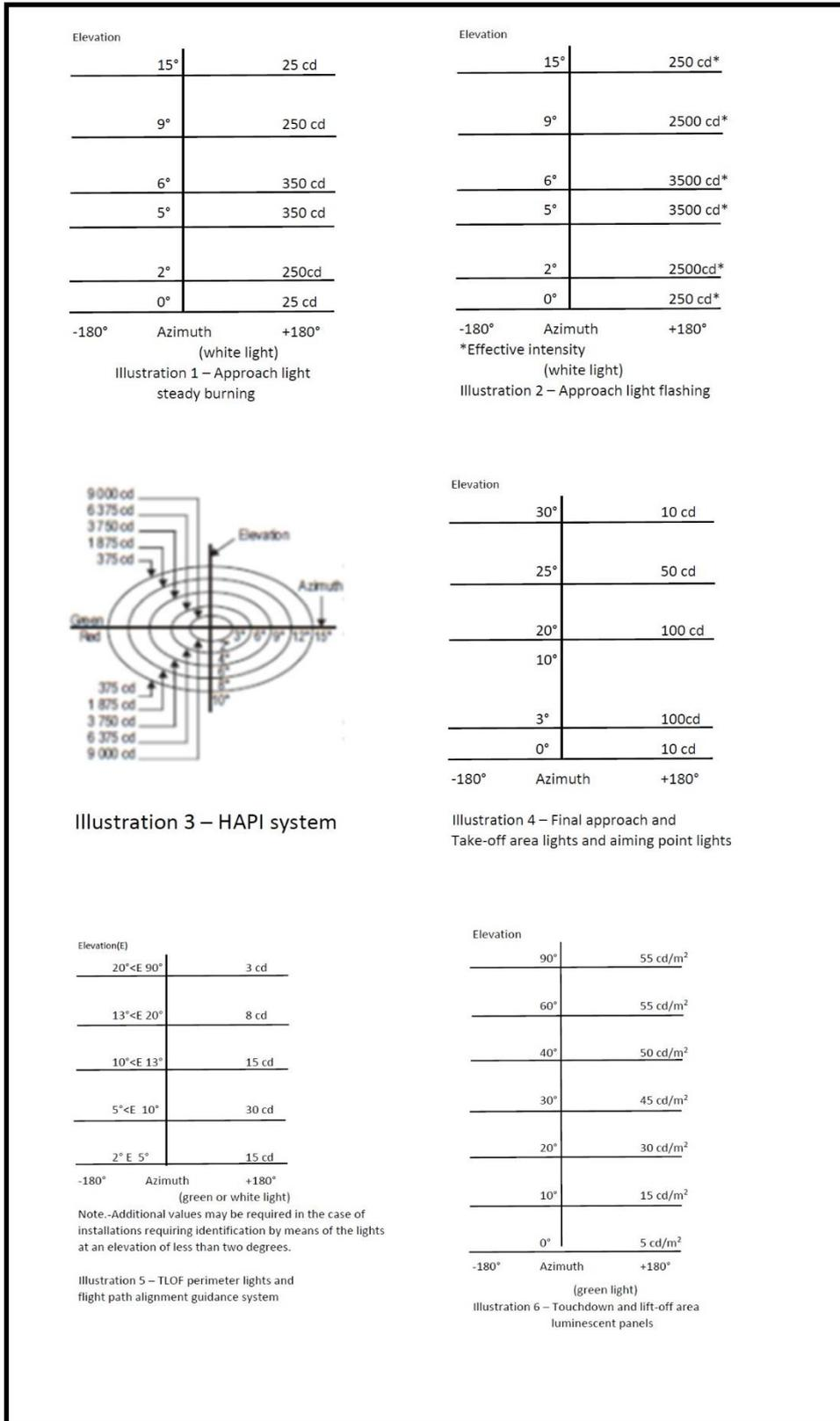
Figure F-6. Isocandela diagrams
