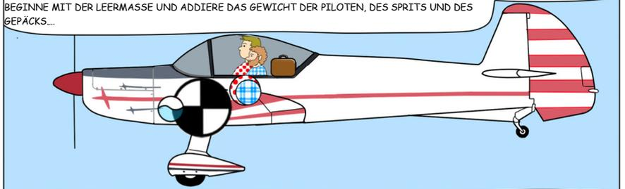
FÜHRE DIE BERECHNUNG FÜR DEN ANFANG UND DAS ENDE DES FLUGS DURCH. ACHTE DARAUF, DASS WIR DEN VORDEREN TANK BENUTZEN. DIESER LIEGT VOR DEM SCHWERPUNKT. WÄHREND DES FLUGES WIRD KRAFTSTOFF VERBRAUCHT UND DIE SCHWERPUNKTLAGE ÄNDERT SICH DADURCH.
