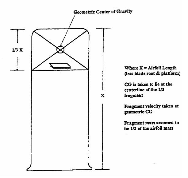
FIGURE 5 – FAN BLADE FRAGMENT DEFINITION
