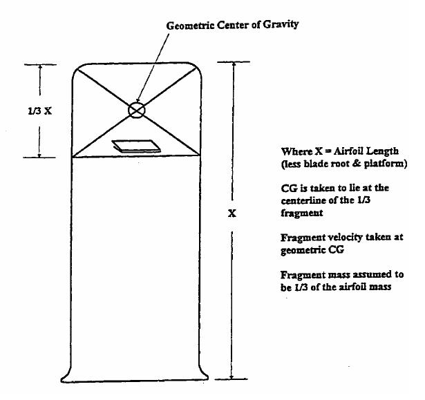
FIGURE 5 – FAN BLADE FRAGMENT DEFINITION
