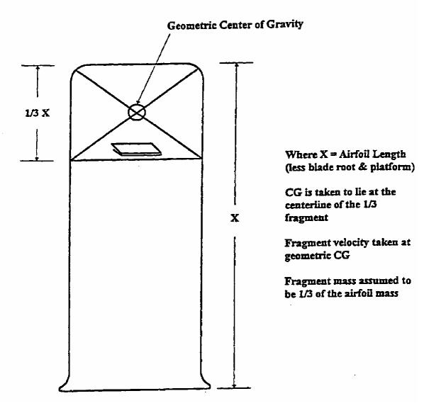
FIGURE 5 – FAN BLADE FRAGMENT DEFINITION
