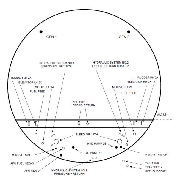
TYPICAL LAYOUT OF SYSTEMS IN ROTOR PLANE
