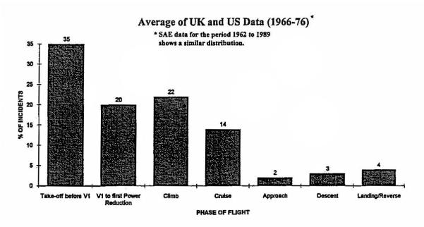
FIGURE 6 – ALL NON-CONTAINMENTS BY PHASE OF FLIGHT
