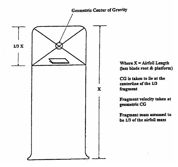
FIGURE 5 – FAN BLADE FRAGMENT DEFINITION
