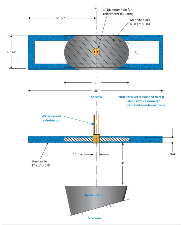
FIGURE 2 CALORIMETER BRACKET
