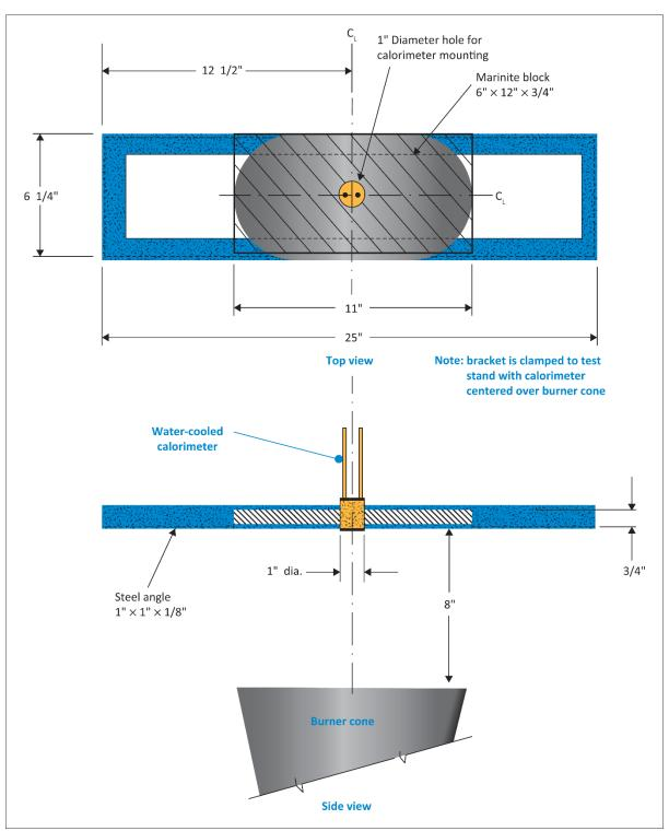
FIGURE 2 CALORIMETER BRACKET
