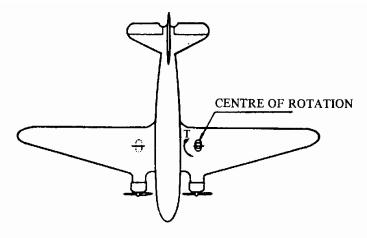
VN AND VM ARE STATIC GROUND REACTIONS. FOR TAIL-WHEEL TYPE THE AEROPLANE IS IN THE THREE POINT ATTITUDE. PIVOTING IS <u>ASSESSED</u> TO TAKE PLACE ABOUT ONE MAIN LANDING GEAR UNIT.
