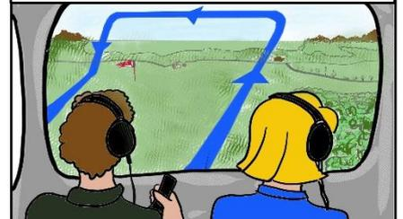
IM QUERANFLUG BEFÜRCHTET SUNNY, DASS JOE DIE HOHE GESCHWINDIGKEIT ÜBER GRUND NICHT WAHRNIMMT UND DIE LANDEBAHN ÜBERKURVEN WIRD.
