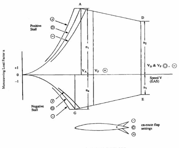
FIGURE 1 MANOEUVRING ENVELOPE
