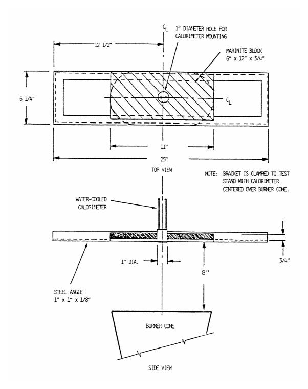
FIGURE 2 CALORIMETER BRACKET
