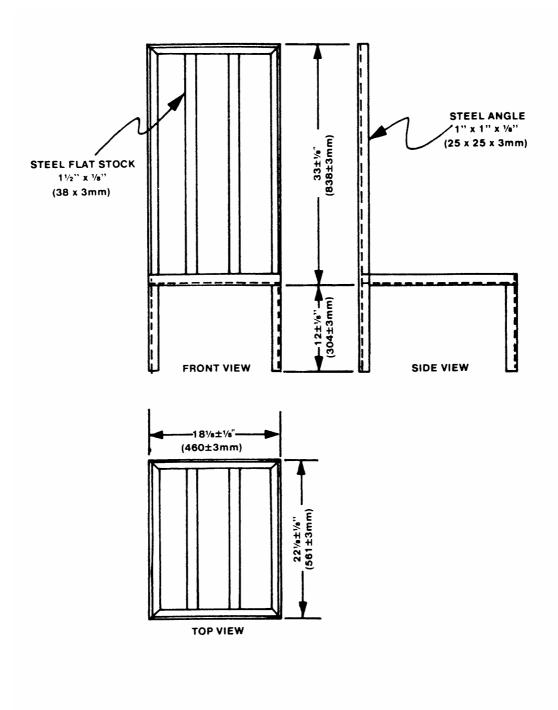
NOTE: ALL JOINTS WELDED FLAT STOCK BUTT WELDED ALL MEASUREMENTS INSIDE
