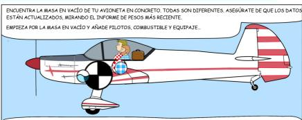
HAZ EL CÁCULO PARA EL PRINCIPIO Y EL FINAL DEL VUELO. TEN ENCUENTA QUE ESTAMOS USANDO EL TANQUE DE COMBUSTIBLE DELANTERO, QUE ESTARÁ POR DELANTE DEL CENTRO DE GRAVEDAD. SEGÚN SE CONSUMA EL COMBUSTIBLE, EL CENTRO DE GRAVEDAD SE MOVERÁ HACIA ATRÁS.
