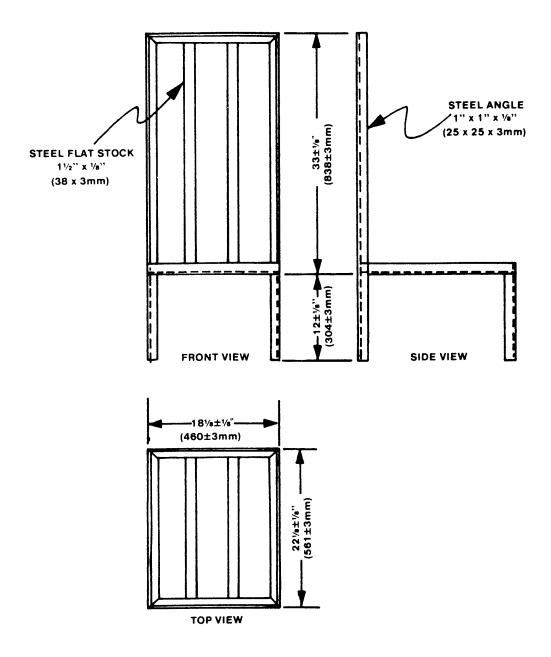
NOTE: ALL JOINTS WELDED FLAT STOCK BUTT WELDED ALL MEASUREMENTS INSIDE
