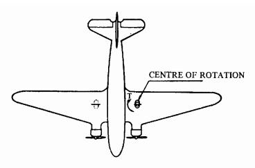
VN AND VM ARE STATIC GROUND REACTIONS. FOR TAIL-WHEEL TYPE THE AEROPLANE IS IN THE THREE POINT ATTITUDE. PIVOTING IS <u>ASSESSED</u> TO TAKE PLACE ABOUT ONE MAIN LANDING GEAR UNIT.
