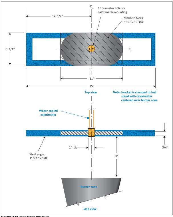
FIGURE 2 CALORIMETER BRACKET
