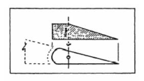
FIGURE B9 AILERON LOAD DISTRIBUTION.
