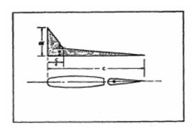
FIGURE B8 TAIL SURFACE LOAD DISTRIBUTION.
