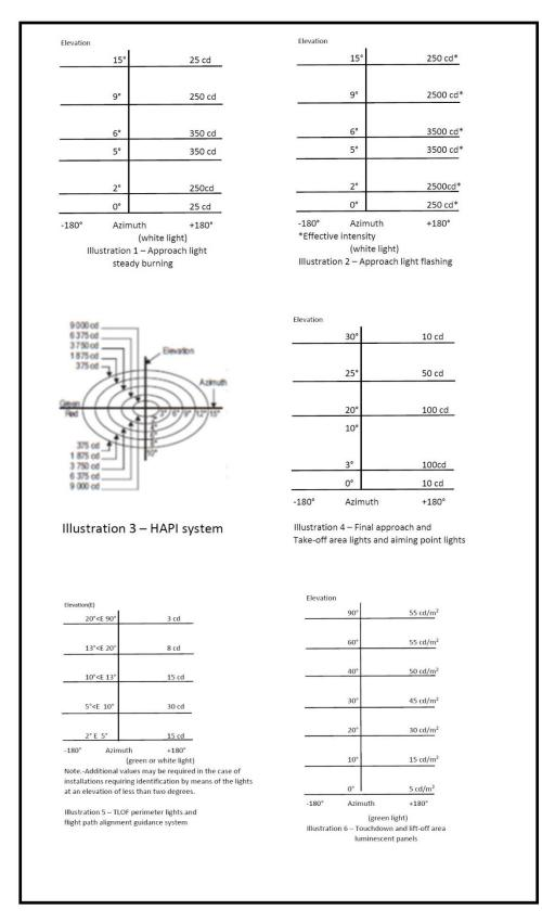
Figure F-6. Isocandela diagrams
