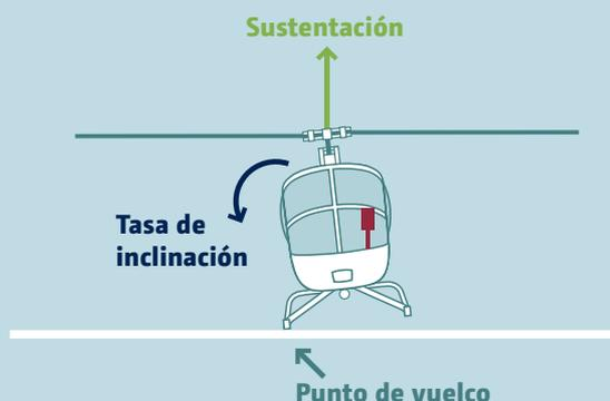
en pendientes. Un vuelco dinámico puede ocurrir con ángulos de vuelco muy inferiores a los ángulos de vuelco estático o crítico.
